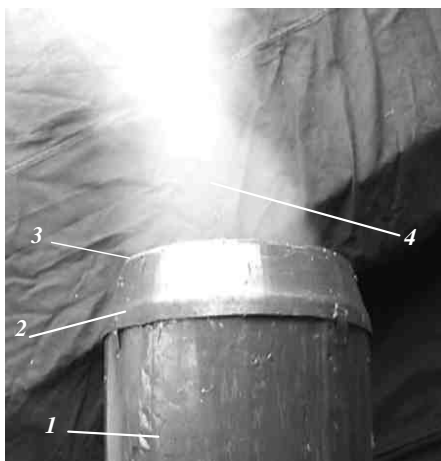
Рис. 3. Экспериментальное исследование новой конструкции оголовка дымовой трубы № 1 на модели со сносящим воздушным потоком:
