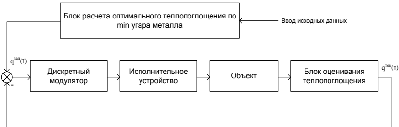
Рис. 1. Двухуровневая система управления нагревом металла
