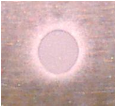
Рис. 1. Фотография полученного отверстия при электрохимической обработке никеля
