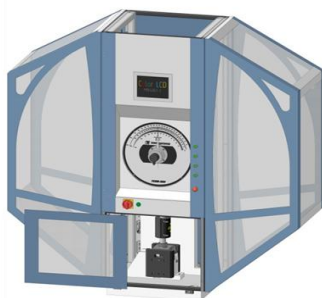
Рис.1. Копер маятниковый ТСКМ-300: а) общий вид копра; б) трехмерная модель маятника
