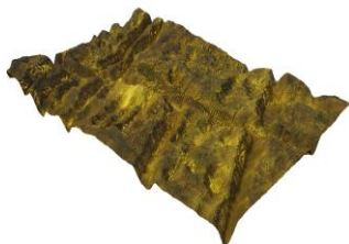
а) Шероховатость R_a=0,872\text{мкм} , СОТС с составом №1. Увеличение \times 40
