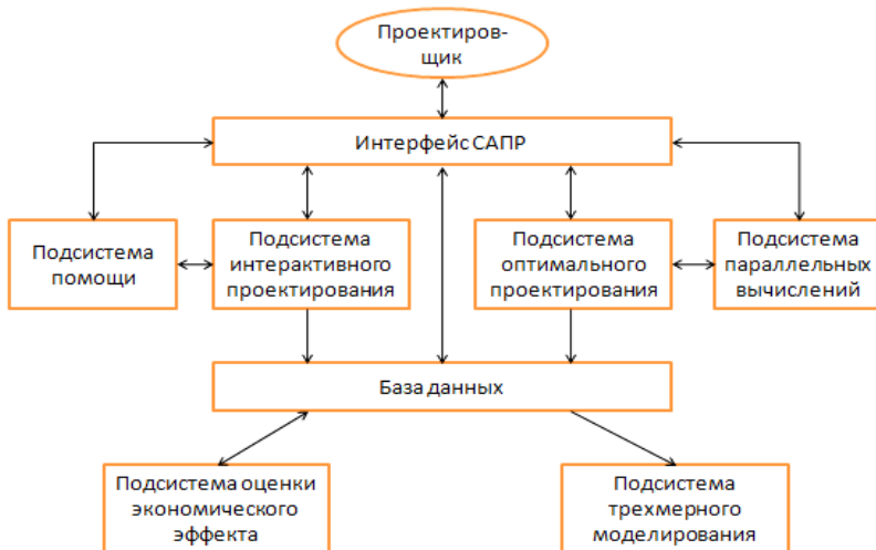
Рис. 1. Структура САПР трансформаторов
