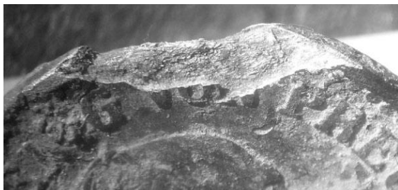
Рис 1. Серебряный грош 1868 г. Разрушения, вызванные интеркристаллической коррозией
