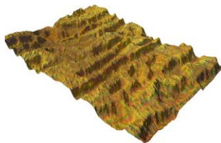
а) Шероховатость R_a=0,845\text{мкм} , СОТС с составом №2. Увеличение \times 40
