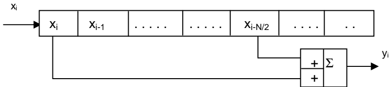
Рис. 2. Фильтр, подавляющий нечетные гармоники
