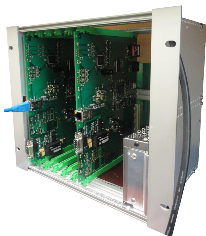
Рис. 14. Макетный образец централизованного микропроцессорного устройства защиты от ОЗЗ
