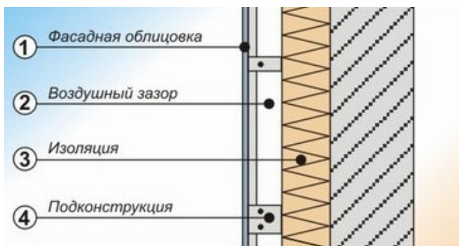
Рис. 1. Конструкция навесного вентилируемого фасада
