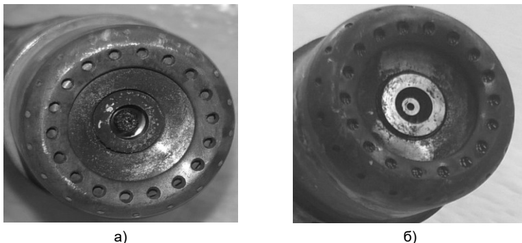
Рис. 6. Фотографии топливной форсунки: а) до очистки; б) после очистки
