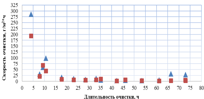
Рис. 2. Зависимость скорости очистки от её длительности (при нагревании):
