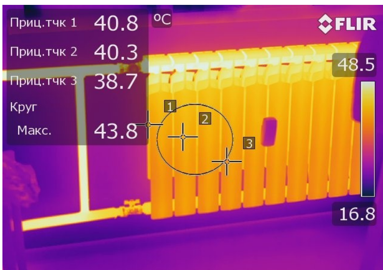
Рис. 1. Фото и тепловая картинка алюминиевого радиатора, подключенного к системе односторонним типом, на радиаторе установлен индикатор тепла Данфосс INDIV-5
