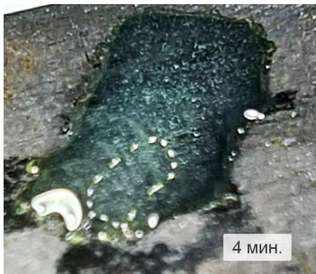
Рис. 3.3а. Оценка коррозионной стойкости защитной пленки (образец Ст20), 4 мин.
