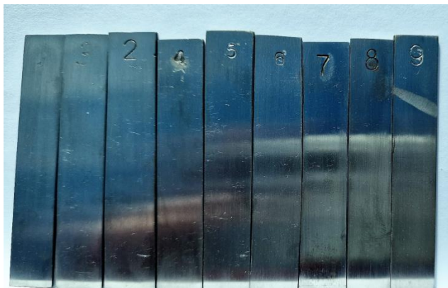
Рис. 3.9. Внешний вид подготовленных образцов металла (индикаторов коррозии) к проведению испытаний
