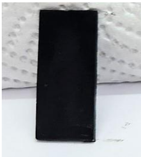
Рис. 3.2. Внешний вид металлической пластинки (индикатора коррозии) после извлечения из автоклава
