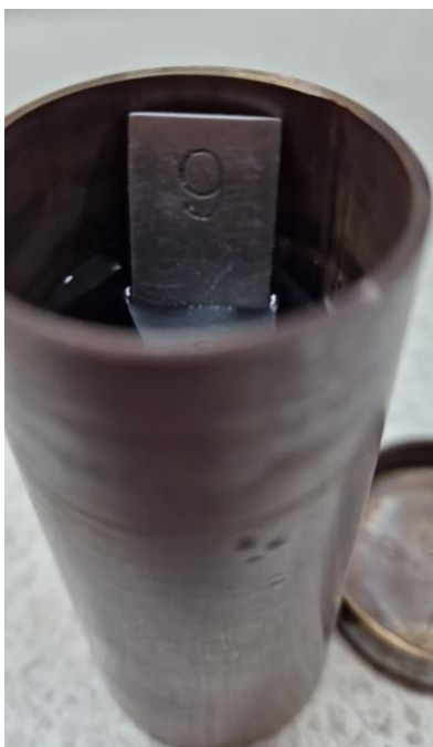
Рис. 2.6. Заполнение капсул рабочими растворами и размещение образца металла Рис. 2.7. Внешний вид запаянных капсул перед установкой в автоклав
