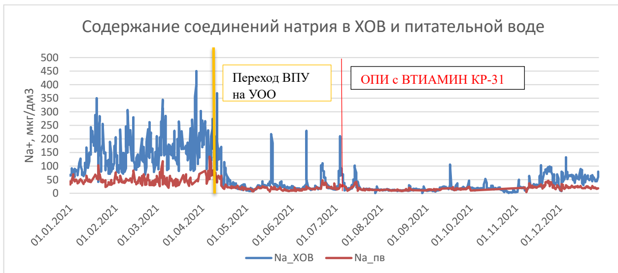
Рис. 4.7. Содержание ионов натрия в питательной воде и ХОВ в период обоих этапов ОПИ
