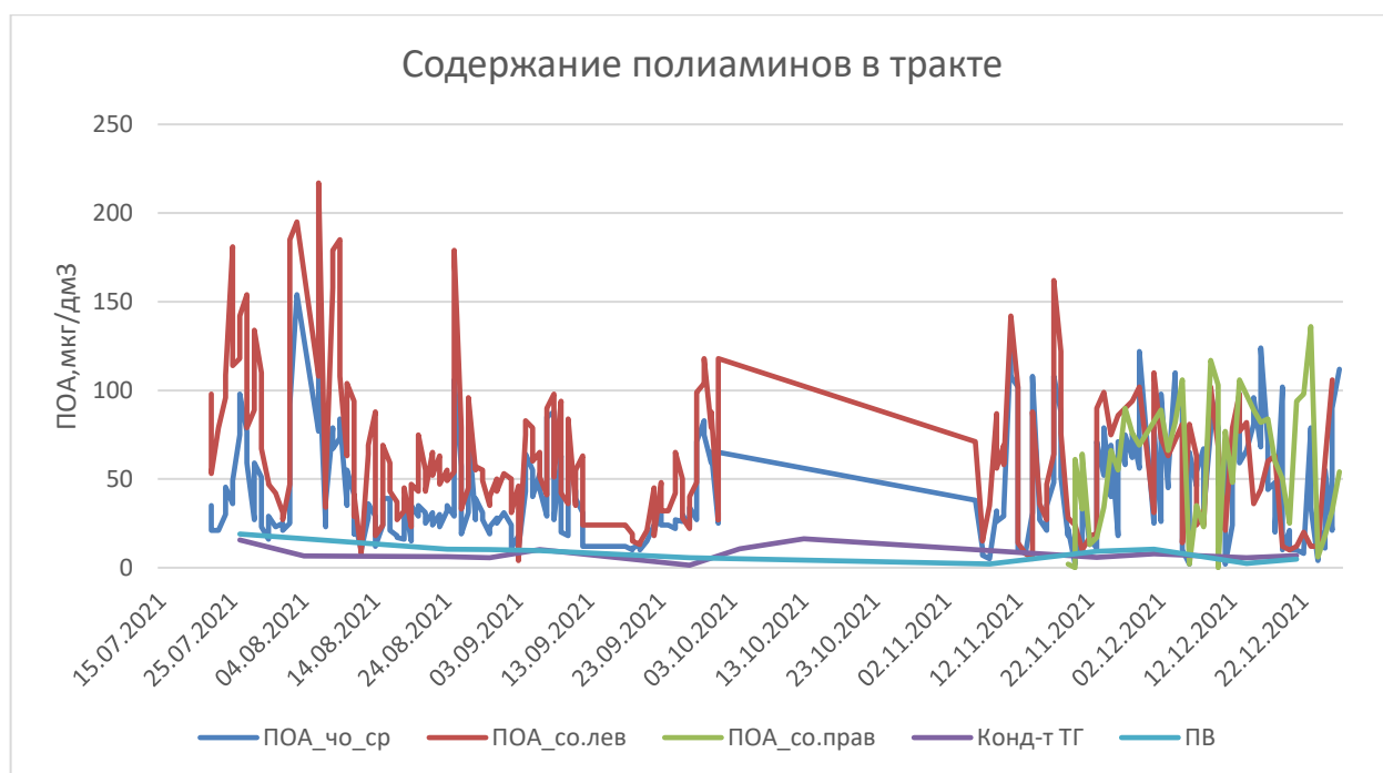
Рис. 4.11. Содержание полиаминов в котловой воде (ПОА_чо_ср, ПОА_со.лев., ПОА_со.прав.), конденсате (Конд-т ТГ) и питательной воде (ПВ)
