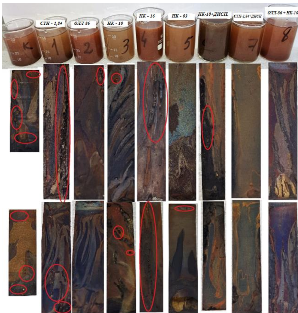
Рис. 3.15. Внешний вид рабочей среды и металлических пластинок после автоклавирования (с выделенными группами язв)
