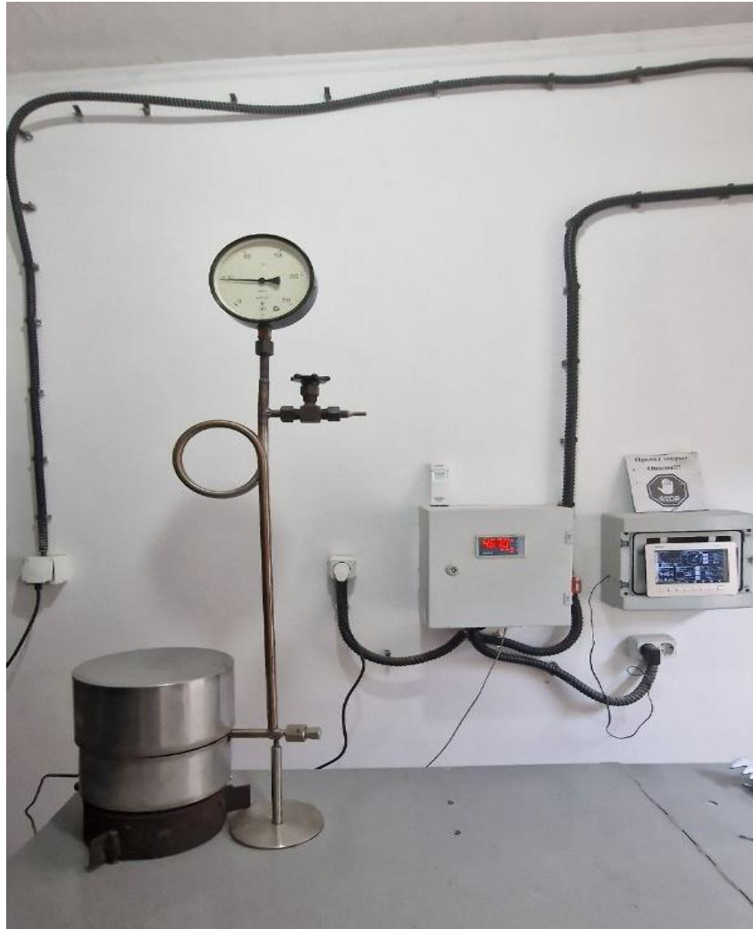
Рис. 2.5. Внешний вид лабораторного автоклава
