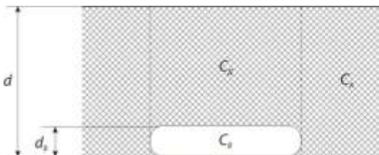
Рис. 1. Эквивалентная схема замещения участка изоляции при рассмотрении механизма возникновения ЧР в толще диэлектрика
