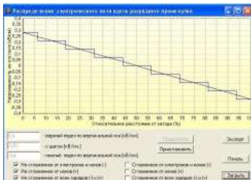
Рис. 4. Изменение напряженности электрического поля вдоль разрядного промежутка для модели и теоретического случая
