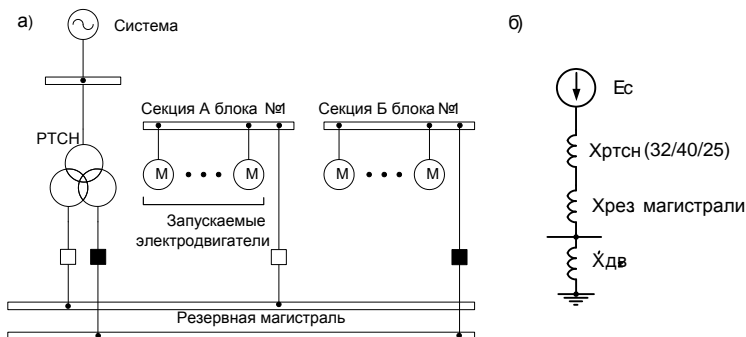
Рис. 2. Упрощенная расчетная схема самозапуска (а) и схема замещения (б)
