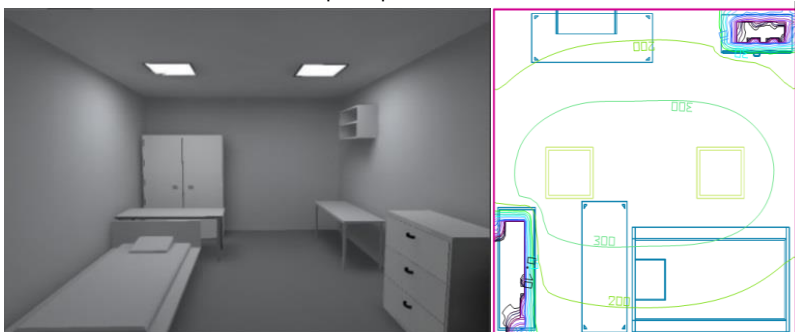
Рис. 2. Общий вид жилой комнаты при расположении светильников по ширине потолка и результаты расчета
