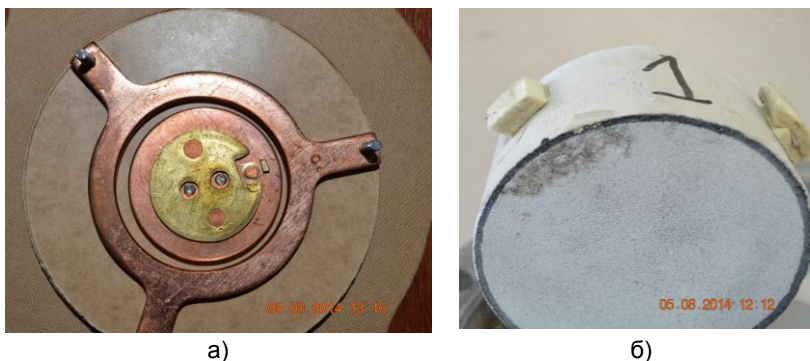
Рис. 1. Элементы РВМГ-110: а – единичный искровой промежуток; б – металлизированная поверхность диска НР со следами оплавления
