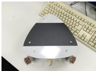
Рис. 2. Пластина со светоотражающими наклейками
