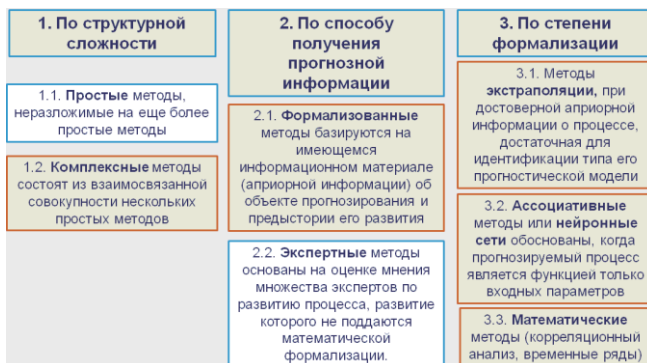
Рис. 1. Классификация методов прогнозирования ТС ЭГПА
