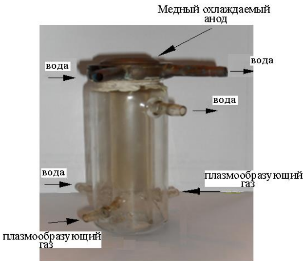
Рис. 3. Фотография головки технологической плазменной электротермической установки
