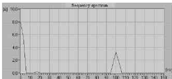
Рис. 3. Спектр вектора Парка с замыканиями в обмотке статора
