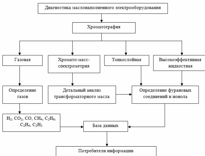
Рис. 1. Диагностика маслонаполненного электрооборудования
