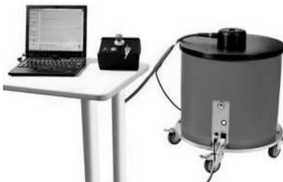
Рис. 1. Система OWTS M 28 для измерения и локализации ЧР в кабельных линиях
