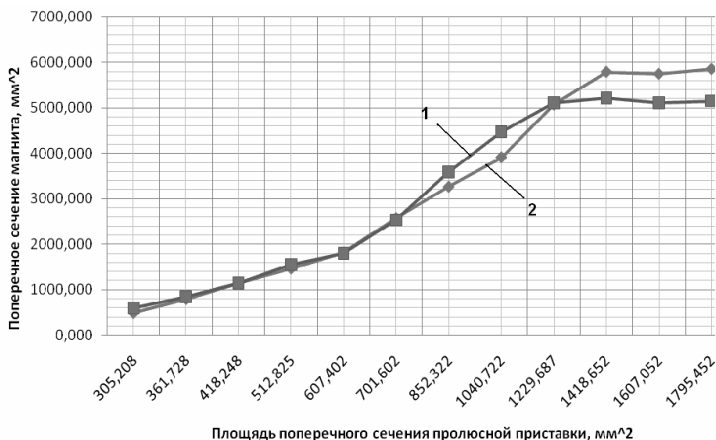
Рис. 3. Графики зависимости отношений площадей поперечного сечения магнита, к поперечному сечению полюсной приставки: 1 – МЖГ газовых сред; 2 – вакуумный МЖГ
