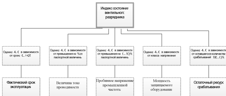
Рис. 1. Упрощённый пример формирования оценки состояния вентильного разрядника
