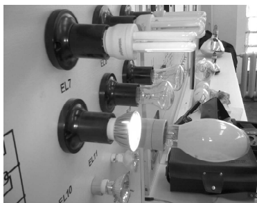
Рис. 1. Установка для исследования светодиодов
