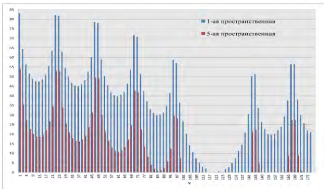
Рис. 3. Уровни электромагнитных шумов от высших временных гармонических полей, вызванных несинусоидальностью питающего напряжения ПЧ с ШИМ для наиболее выраженных 1 и 5 пространственных
