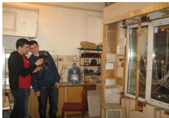
Рис. 2 Тепловизионная съёмка в климатической камере АНО «Ивановстройиспытания»
