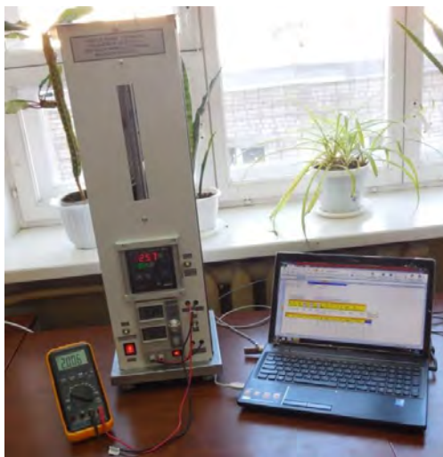
Рис. 1. Лабораторный стенд по определению изобарной теплоемкости воздуха
