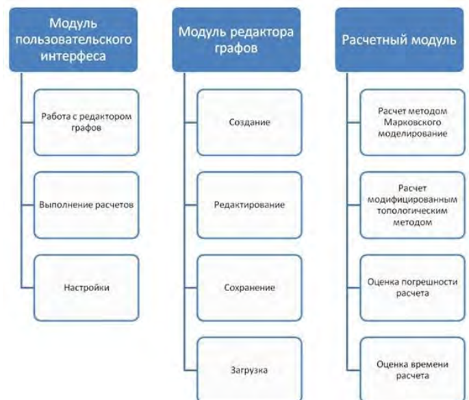
Рисунок 6. Структура программного комплекса для расчета показателей надежности технических систем
