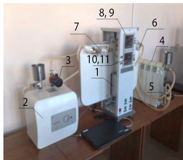
Рис. 3. Экспериментальная установка: 1 – пластинчатый теплообменник; 2 – водонагреватель; 3 – насос водонагревателя; 4 – радиатор (холодильник); 5 – насос радиатора; 6, 7 – измерители расхода горячего и холодного теплоносителей; 8, 9 – измерители температур; 10, 11 – электронные расходомеры
