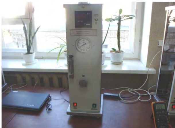
Рис. 1. Лабораторный стенд по изучению эффекта Джоуля-Томсона
