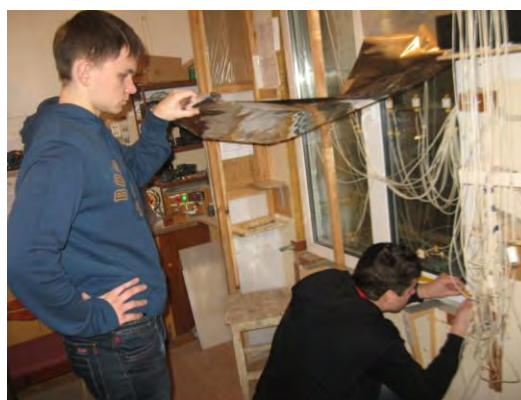
Рис. 3 Монтаж теплоотражающих экранов и установка датчиков
