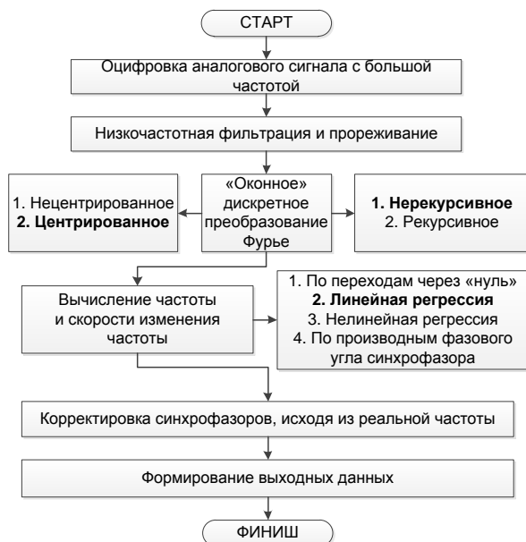
Рисунок 1. Блок-схема комплексного алгоритма, имитирующего функционирование УСВИ
