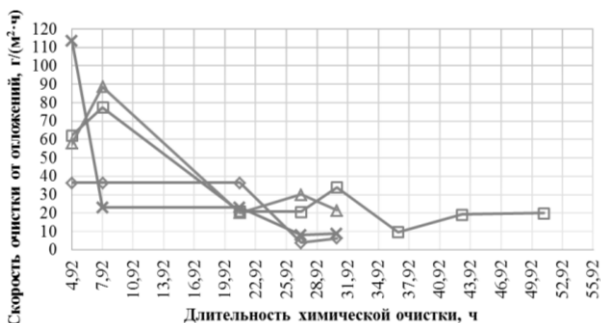
Рис. 1. Зависимость скорости очистки в кислотных растворах от её длительности (условия химической очистки (ХО): очистка от равномерных отложений, без нагрева; ◇ – Дескам; □ – Auce Pro Ac 60; Δ – Auce Pro Ac 60H; × – Антиржавин)
