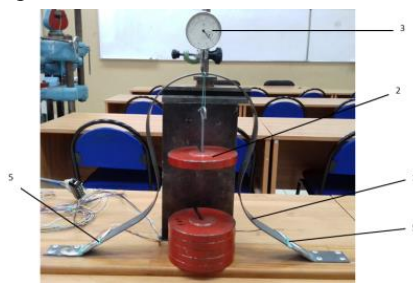
Рис. 1. Экспериментальная установка: 1 – жестко закрепленный омегаобразный брус; 2 – груз 1 кг; 3 – прибор для измерения перемещений; 4 – тензометрический измеритель деформаций; 5 – тензодатчики
