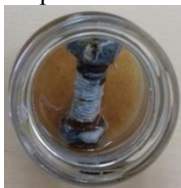
Рис.1. Болт М12 в растворе поваренной соли
