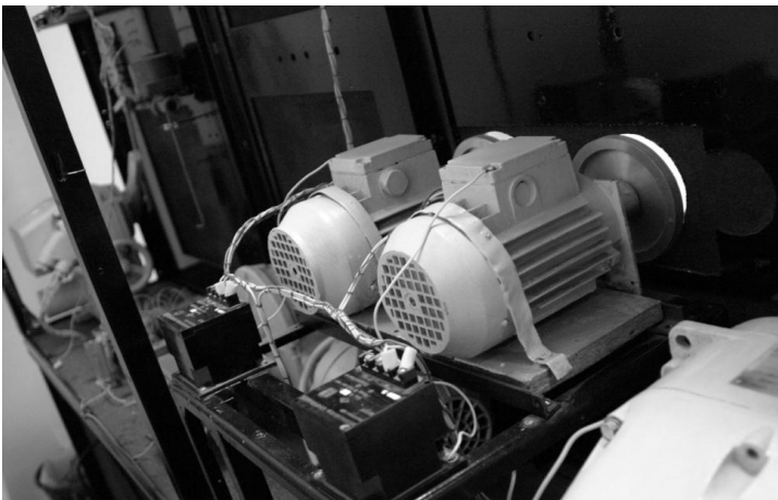
Рис. 2. Стенд исполнительных устройств: а – лицевая информационная панель; б – исполнительные устройства
