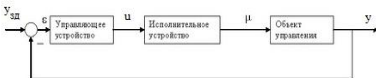
Рис. 1. Типовая одноконтурная схема автоматического регулирования
