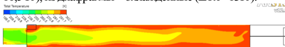
Рис.1. Энергоразделение в противоточной вихревой трубе ( d_1 = 20 \text{ мм} ; \bar{L} = 9 ; P_1^* = 0,4 \text{ МПа} ; F_1^* = 0,1 ; F_2^* = 0,5 , \mu = 0,3 )
