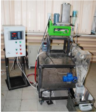
Рис. 2. Экспериментальный стенд «Модель реактора УТТ»
