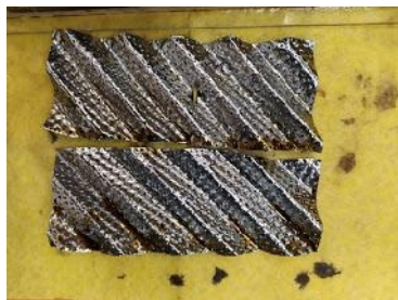
Рисунок 1 – Вставки с гофрированными перегородками, расположенных под углом 135^\circ
