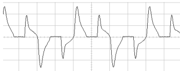
Рис. 2. Осциллограмма неравномерной нагрузки фазы LED (5 В, 5 мс)
