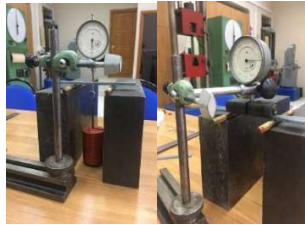
Рис.1.Сосредоточенная сила \Delta P=2H Рис.2.Распределенная нагрузка \Delta P=2H
