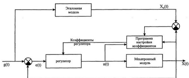
Рис.1 Блок-схема адаптивной системы с эталонной моделью
