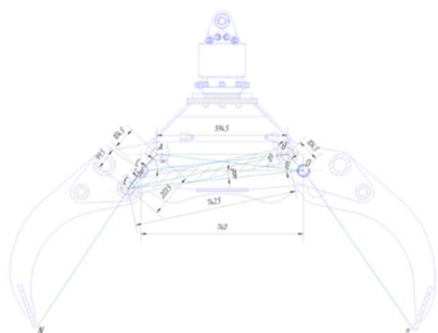
Рис.1-Расчетная схема грейфера
