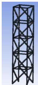
Рис.1. Модель после проведения топологической оптимизации
