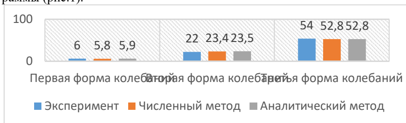
Рисунок 1 – Диаграмма сравнения методов исследования колебаний пластины, закрепленной по контуру
