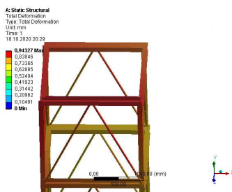
Рис. 1. Деформации конструкции с учетом дефекта
