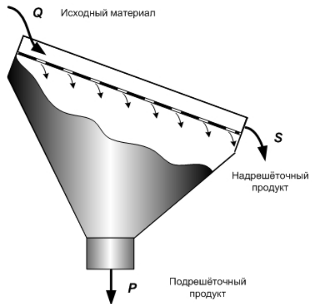
Рис. 2. Принципиальная схема односитного грохота
