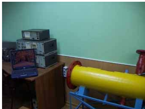
Рис. 4. Стенд для вибродиагностики качества вальцовочных соединений бойлерной установки
