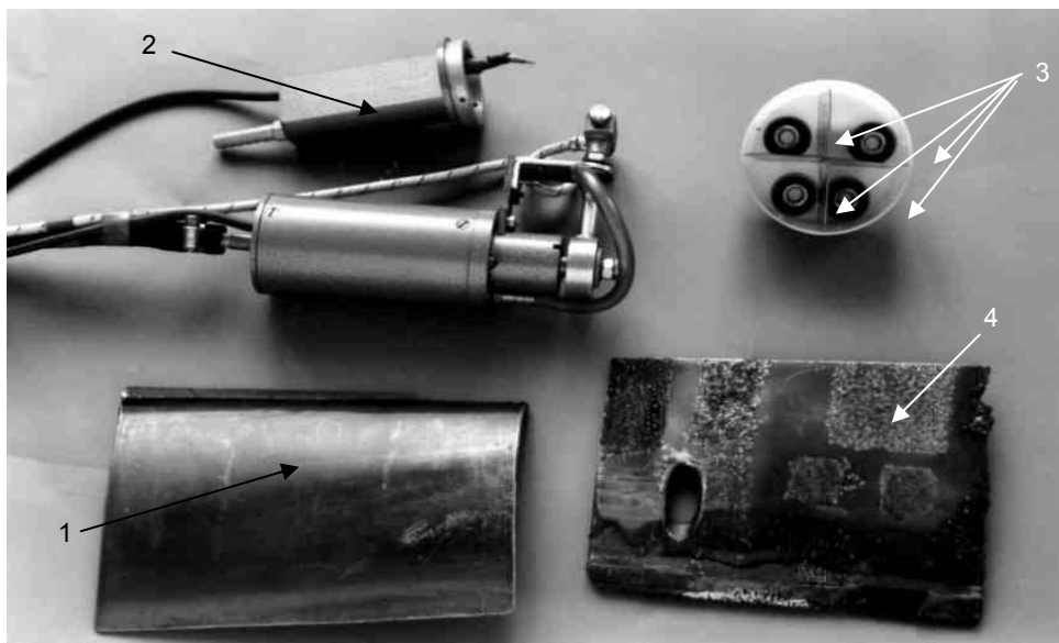
Рис. 3. Внешний вид электромеханического вибратора: 1 – вибратор без съемной рукоятки; 2 – съемная рукоятка; 3 – сменные эксцентрики; 4 – образец формируемого покрытия
