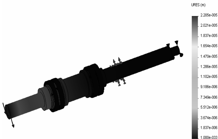
Рис. 4. Напряженно-деформируемое состояние шпиндельного узла с вылетом расточного шпинделя L = 390\text{ мм}
